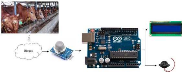
Gambar 7. Perancangan Hardware Secara Keseluruhan
